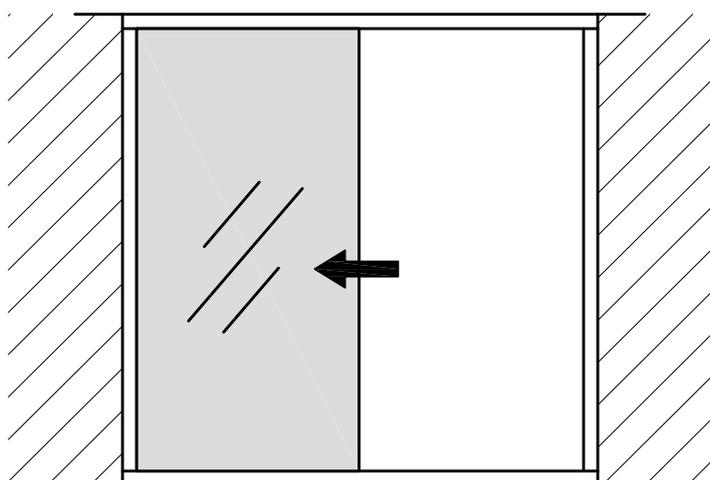
Note: Pour la pose du vitrage, insérer celui-ci dans la lisse haute et basse de la cloison.
