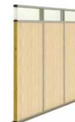
Plein sous imposte double ou simple vitrage.
