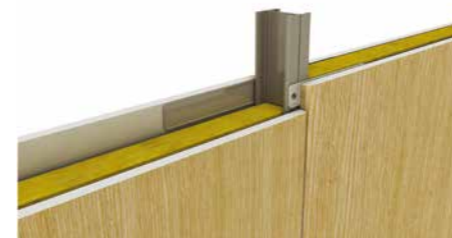
Collage et vissage de la languette acier sur 1 bord de la plaque de plâtre à chants rebordés.
