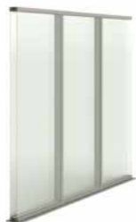
Simple ou double vitrage toute hauteur. Hauteur maximale 3ml. Trame de l'ossature 1,2ml. PV Garde corps.
