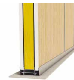
Prise en feuillure des plaques entre lisses.
