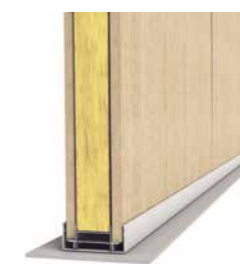
Prise en feuillure des plaques entre lisses.
