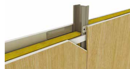
Collage et prise en feuillure de la languette acier sur l'autre bord de la plaque de plâtre à chants rebordés.
