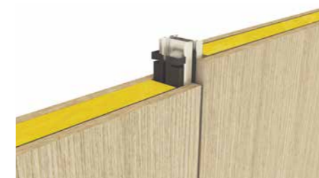
Vissage et mise en préhension des clips i-fil sur les panneaux et les montants. Habillage du joint creux par clipsage du joint i-fil dans la rainure du montant.
