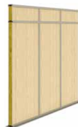
Plein sous imposte pleine. Hauteur maximale 3,5ml. Trame de l'ossature 1,2ml.
