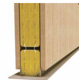
Pose du 1 er panneau sur une traverse parfaitement horizontale.
