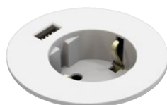
935-PM61W POWERDOT MIDI, WIT 1 STROOM, 1 USB LADER (2.1 A) 1.7 M CONNECTIE (SCHUKO) VAST NIVEAU. HOOGTE 82 MM.
